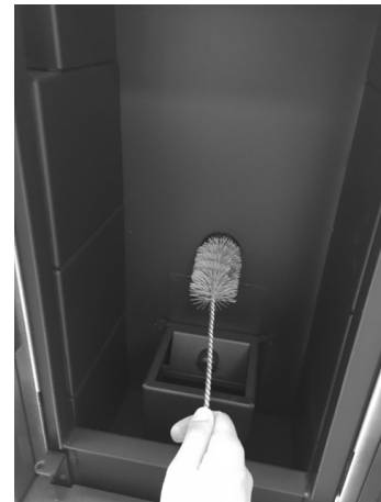
Fig. 11 - Reinigung mit Flaschenbürste
