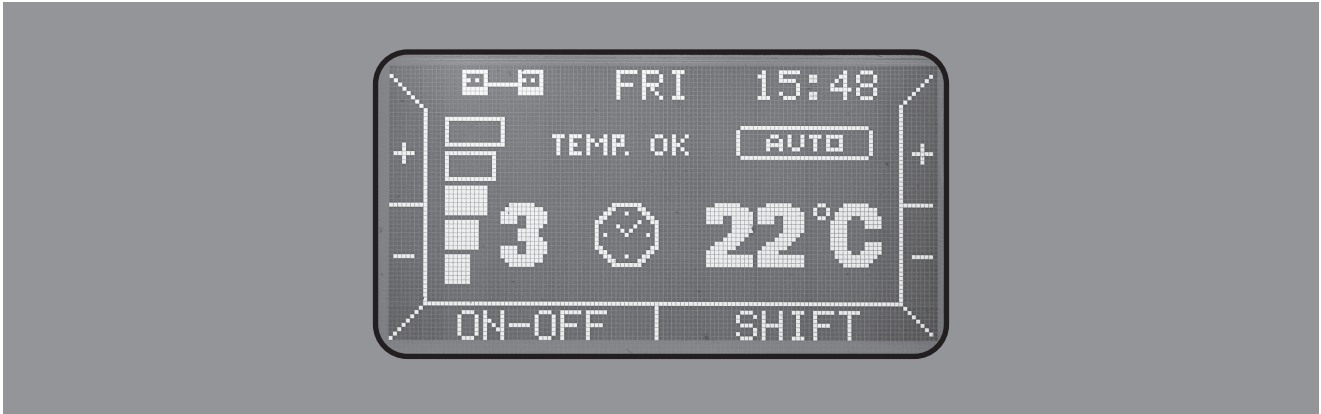
Abb. 11: Display-Anzeige bei Automatikbetrieb
