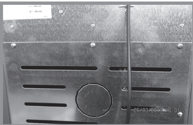
Abb. 13d: Aussaugen der Frontplatte
