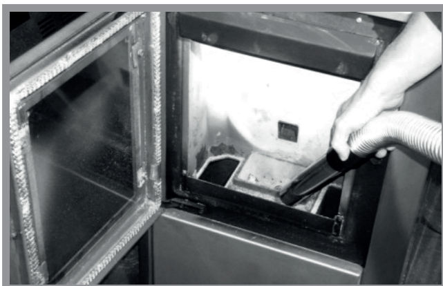
Abb. 12a: Reinigung des Brenntopfes
