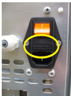
Fig. 82 - Abdeckklappe mit Sicherungen, die ausgewechselt werden müssen
