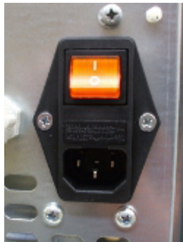
Fig. 50 - Elektrische Steckdose mit Hauptschalter
