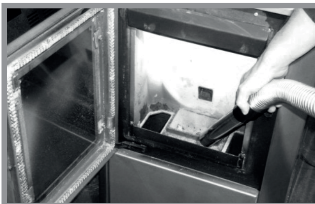
Abb. 12a: Reinigung des Brenntopfes
