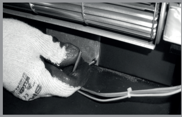
Abb. 13b: Aufschauben der inneren Abdeckplatte
