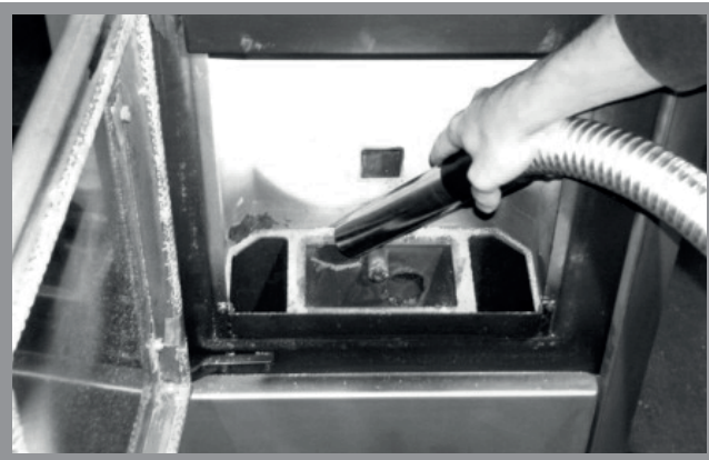
Abb. 12d: Reinigung der Topfhalterung
