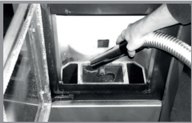
Abb. 12d: Reinigung der Topfhalterung
