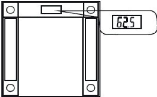
5. Sie können sich nochmals innerhalb von 10 Sekunden ohne Abschaltung der Anzeige wiegen. Nach 10 Sekunden ohne Belastung stellt sich die Waage automatisch ab.
