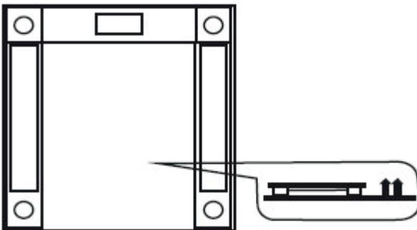
3. Stellen Sie sich wie angezeigt auf die Waage, um die Anzeige einzuschalten. Sie springt automatisch auf 0.
